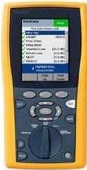
Şəkil 3.11. Kabel test avadanlığı
